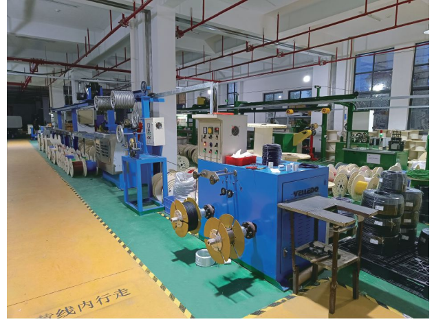
线缆生产流水线
